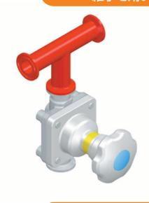
●純水や薬液が循環しているプロセスより ユースポイントに取り出す場合は、図のようにチーズ継手とバルブを用います。 しかし、この場合は大きなデッドスペースが 発生します。
