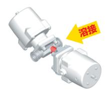
●このデッドスペースを小さくするため、チーズ継手を排除し、バルブボディに直接もうひとつのバルブを溶接します。しかし、この場合も溶接を行うための短管部がデッドスペースとして残ります。
