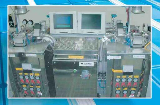
本検査装置は精密バルブ機器の検査に使用するために 開発、製作した高感度のリーク検査装置です。
